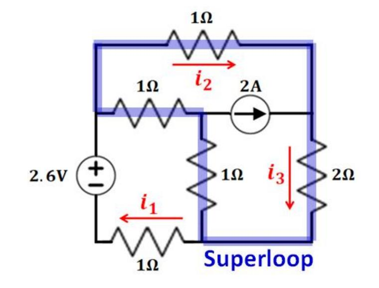
**3**  $1\Omega i_2 + 2\Omega i_3 + 1\Omega(i_3 - i_1) + 1\Omega(i_2 - i_1) = 0$
