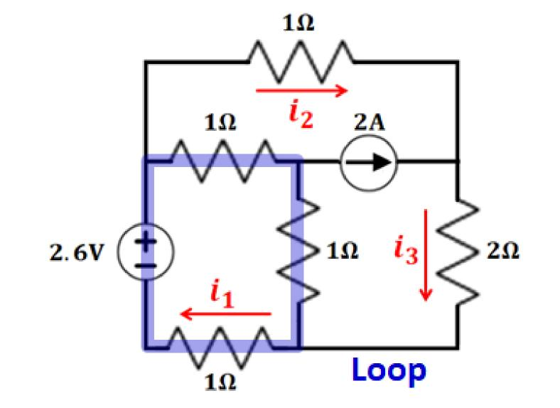
(1)  $-2.6V + 1\Omega(i_1 - i_2) + 1\Omega(i_1 - i_3) + 1\Omega i_1 = 0$
