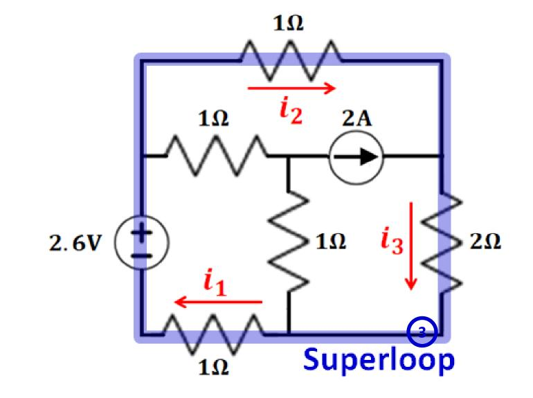
$-2.6V + 1\Omega i_2 + 2\Omega i_3 + 1\Omega i_1 = 0$
