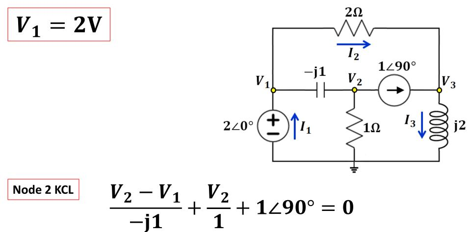
$jV_2 - 2j + V_2 + j1 = 0$   $V_2(1 + j) = j1$
